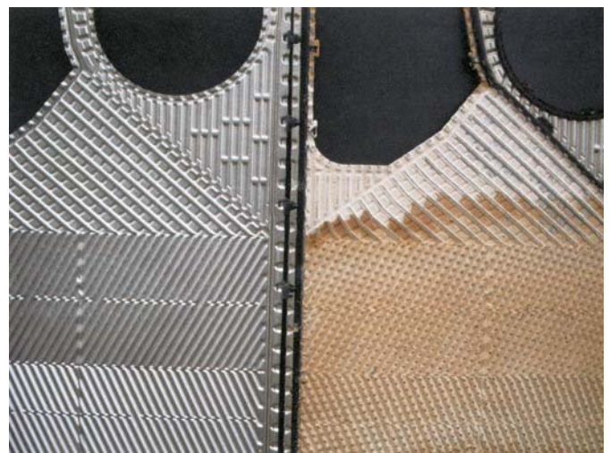
Abb. 1: Oberfläche einer Wärmeübertragerplatte eines Plattenverdampfers EC 500
